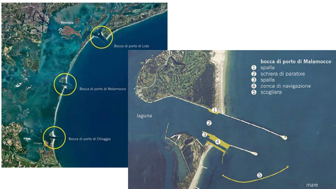
1. Bocche di porto di Venezia e cassoni di soglia e di spalla
